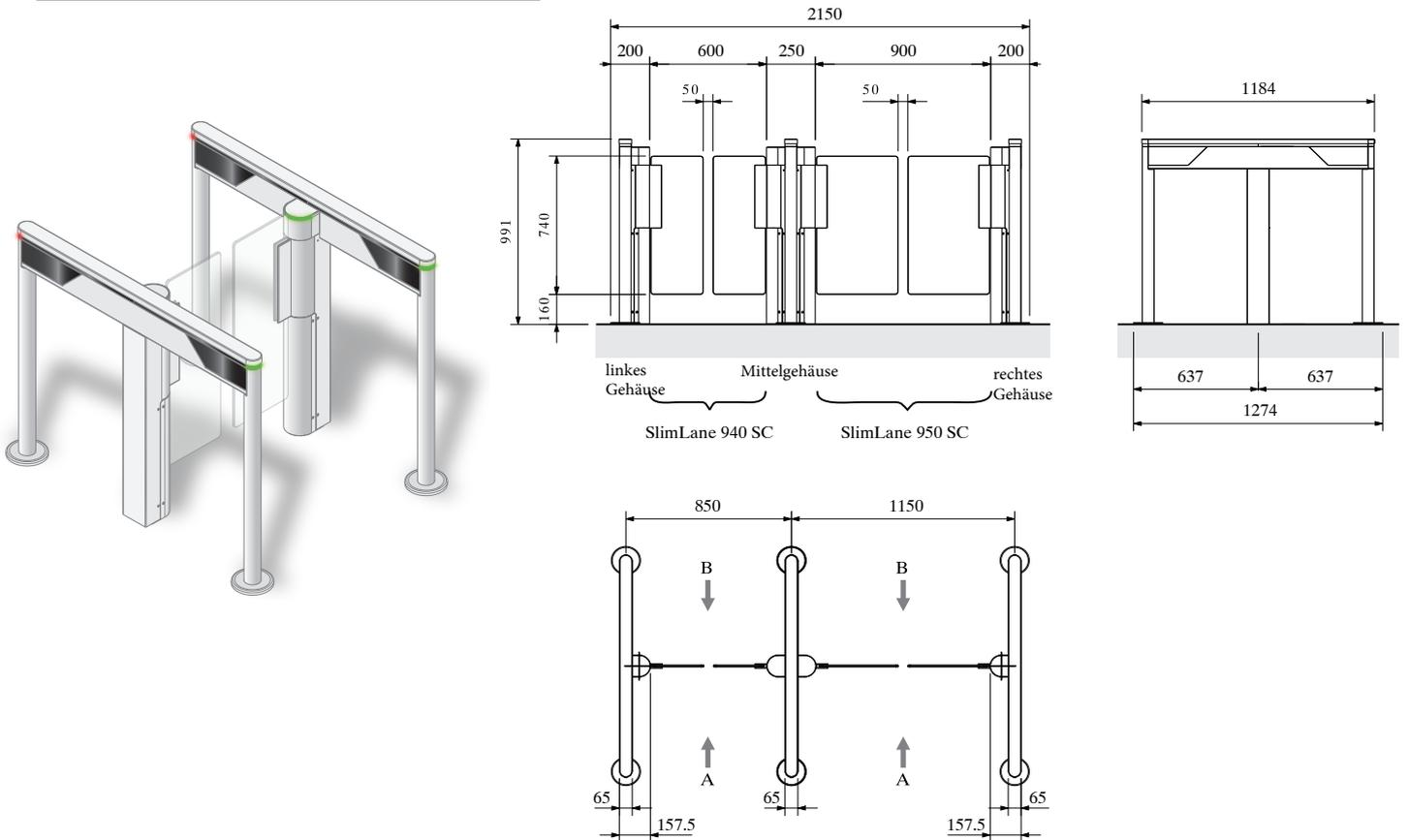
**Standardabmessungen SlimLane 940 EP (Option Erweiterungsgehäuse)**
